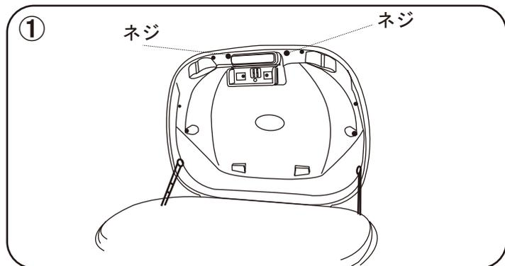
① トップカバー裏側・タッピングスクリュー2か所を外します。
