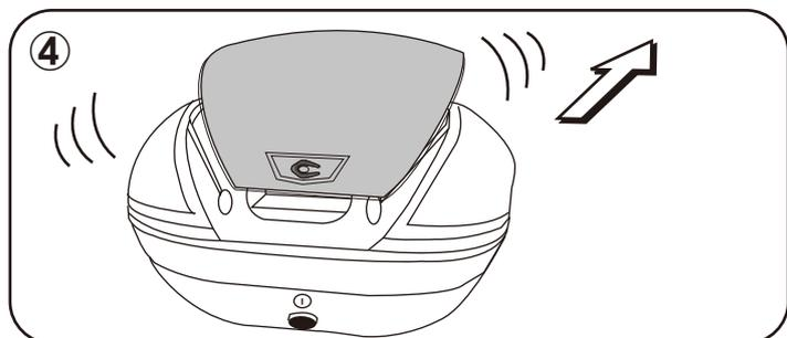
トップリッド後方の爪を外す場合は、左右に少し振りながら、後ろ側へずらすようにして取り外してください。
