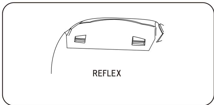
トップリッド後方の固定方法は、図のようにトップカバーに溝が切っており、トップリッドの爪が入り込むようになっています。
